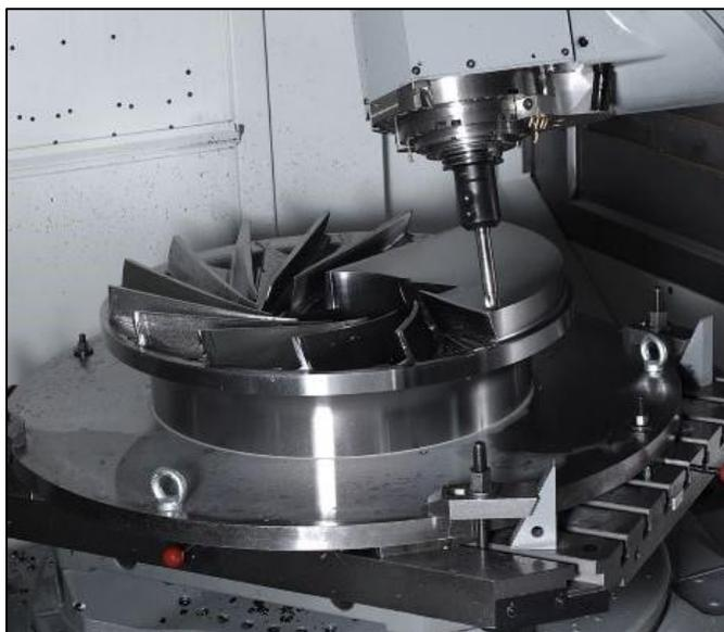
多軸加工機械によるランナ加工
