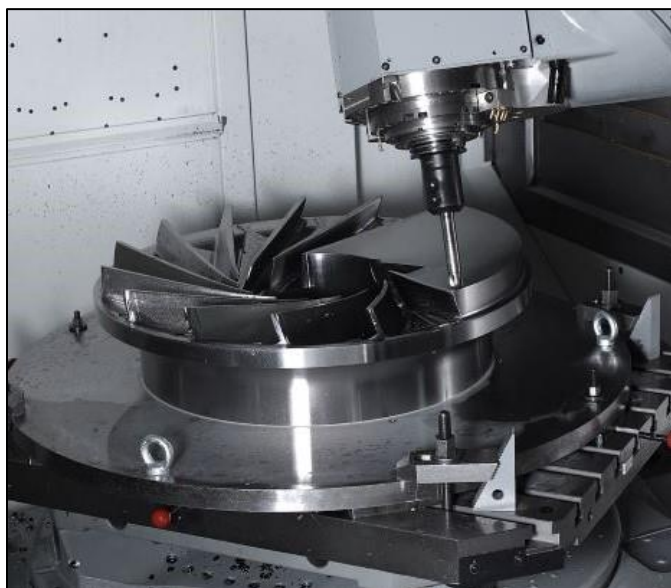
多軸加工機械によるランナ加工 (出展: Global Hydro Energy社 Website)
