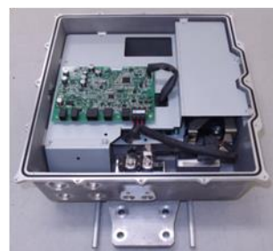
発電コントローラ
