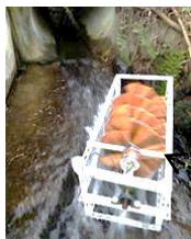
木製螺旋水車デモ 木製水車設置(予定)
