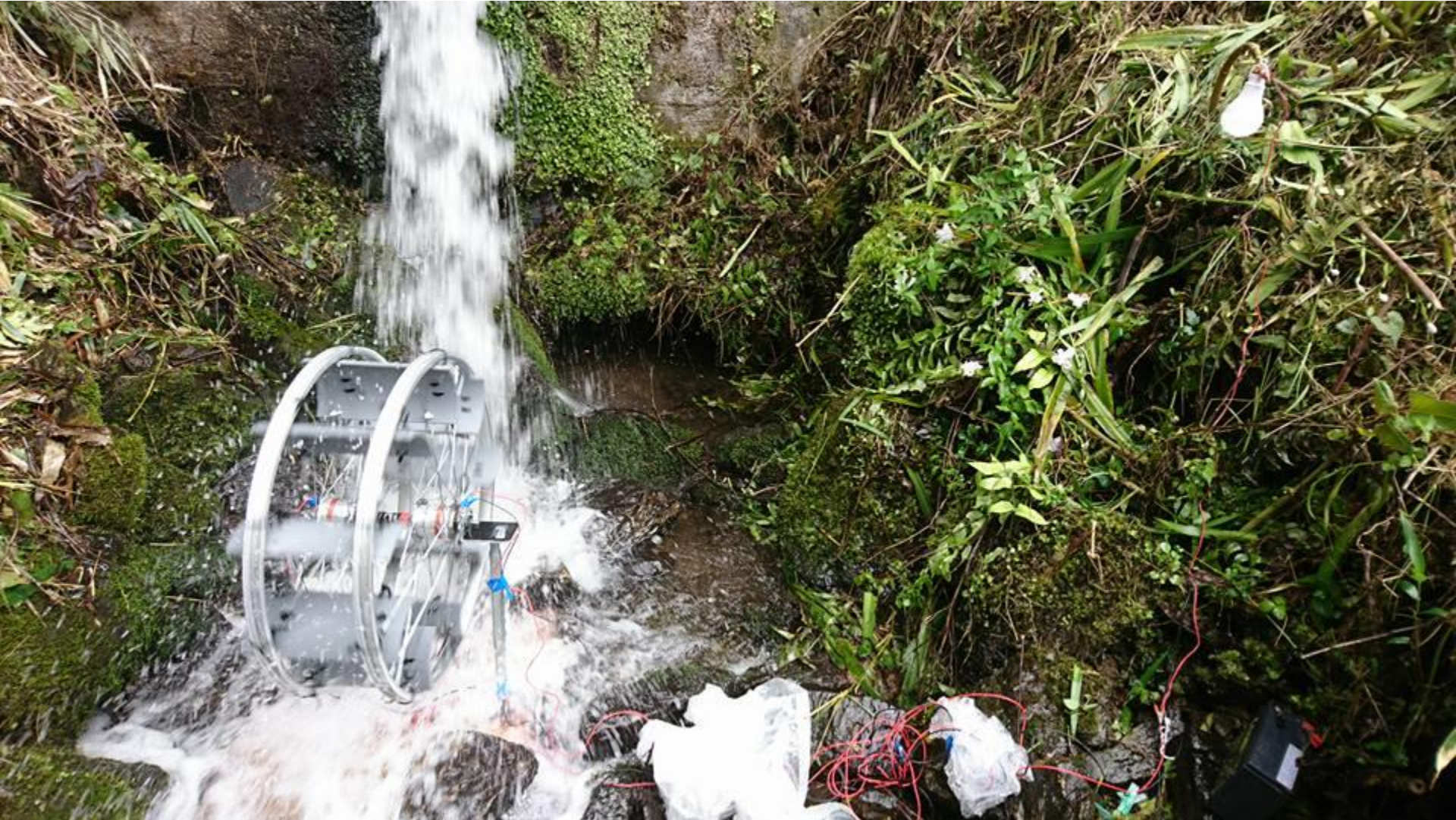
2017 6 吉野町 河原屋地区 農業用水の余水吐での実験 リムダブル1号を開発
